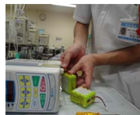
バッテリー交換、点検
